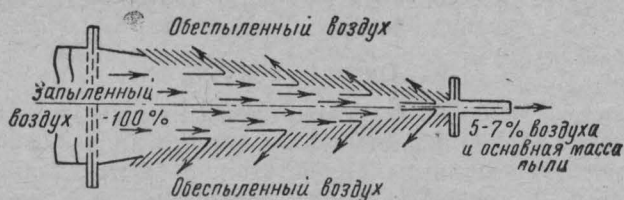
Рис. 37. Инерционный пылеотделитель
